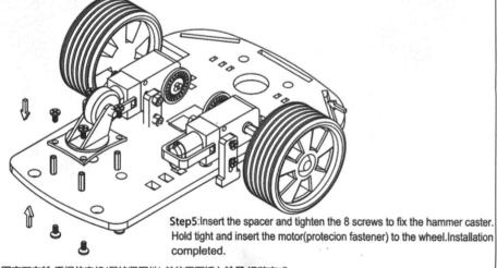
Step5:放入铜柱,拧进8个螺丝固定万向轮,手捏住电机(保护紧固件),并往里面插入轮子,组装完成
