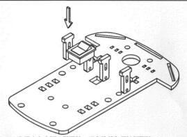
Step1:先把小车底板、紧固件、码盘的黄色保护纸撕掉,然后把紧固件插入小车底板
